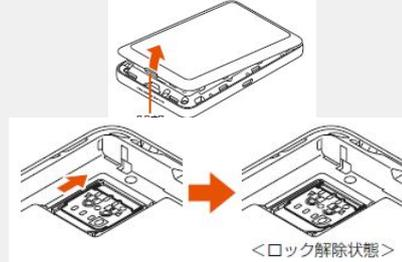
2. スロットを立ち上げてUIMカードの金属面を上側にして、スロットにまっすぐ挿入します
