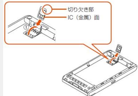
3. カードスロットを倒し、矢印方向にスライドさせ、ロックします。
